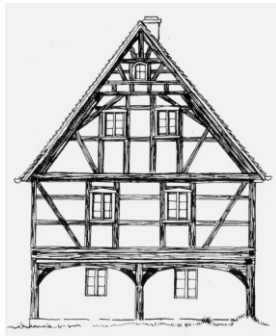
Abb. B-99 Langständer, 1 ½-geschossig, nur einzelne Kopfstreben (Cunewalde, Archiv Beelitz, Ausschnitt) / Abb. B-100 Stockwerkbau, einfacher Fachwerkkorb im Oberstock (Siebitz) / Abb. B-101 rechts: reich gegliedertes Fachwerk mit Andreaskreuzen und Gitterwerk (Karpniki, PL)
